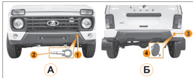
Рис. 33. Расположение вворачиваемых буксирных проушин (в варианном исполнении)
