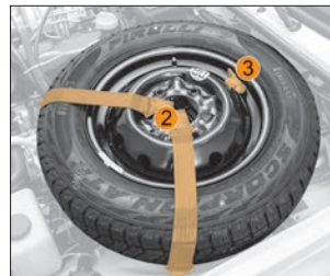
Рис. 44. Укладка и крепление домкрата и запасного колеса
