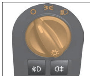
Рис. 14а. Переключатель наружного освещения
